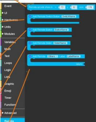
Для того чтобы создать и настроить блок выключателя дистанционного управления кликните на шестерёнку.
