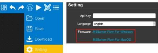
После того, как Вы скачаете архив с прошивальщиком, откройте исполняемый файл. Далее укажите COM-порт, к которому подключен M5 (для пользователей ОС Windows можно узнать с помощью Диспетчера устройств), укажите скорость, выберите интересующую актуальную версию ПО, затем нажмите кнопку Erase, после того как операция стирания памяти будет завершена, нажмите кнопку Burn и дождитесь окончания процесса прошивки в консоли.
